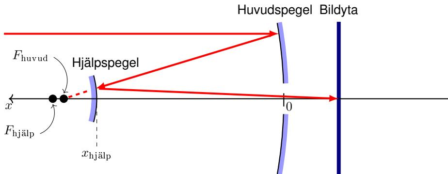
b) [2 p.] Huvudspegelns brännvidd  $f_{\text{huvud}} = R_{\text{huvud}}/2 = 11,04\text{m}/2 = 5,52\text{m}$ . Brännvidden är positiv, eftersom spegeln är konkav. Därmed är brännpunkten  $F_{\text{huvud}}$  5,52 m till vänster om huvudspegelns medelpunkt.
